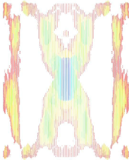
Figure 5.3.15 – Voûte à profile en chainette – Contraintes principales de traction en fibre supérieure, ou elles sont d'amplitude maximale. Les vecteurs bleus correspondent à la plus forte valeur de  $-0.4$  kPa.
