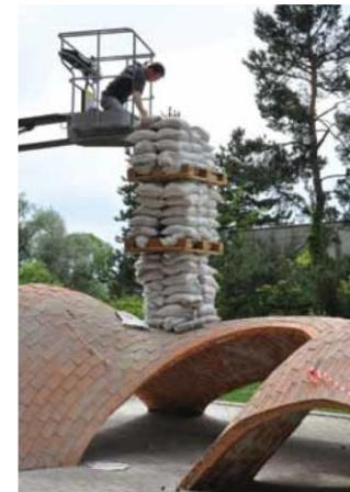
Figure 5.3.3 - Charge concentrée de 3 t appliquée à la structure expérimentale. « Aucune fissuration visible » n'a pu être constatée. [38, p. 53]
