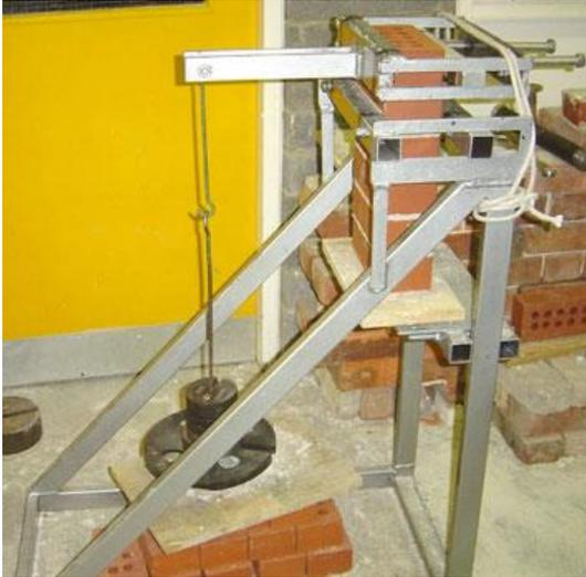
Figure 6.3.19 – Appareillage d'essai utilisé pour les essais de type « bond wrench ». Dans [55, p. 917].
